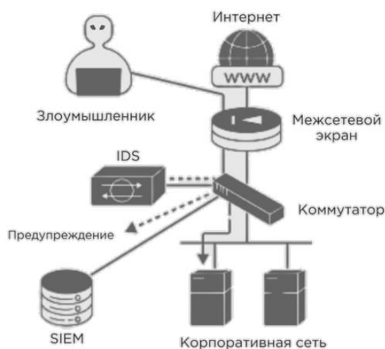
Рис. 1. Архитектура системы с интеграцией SIEM и IDS
