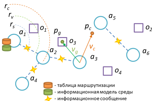
Рис. 1. Схема группы мобильных агентов в режиме одновременного движения к целевым объектам и восполнения потерянных каналов связи
