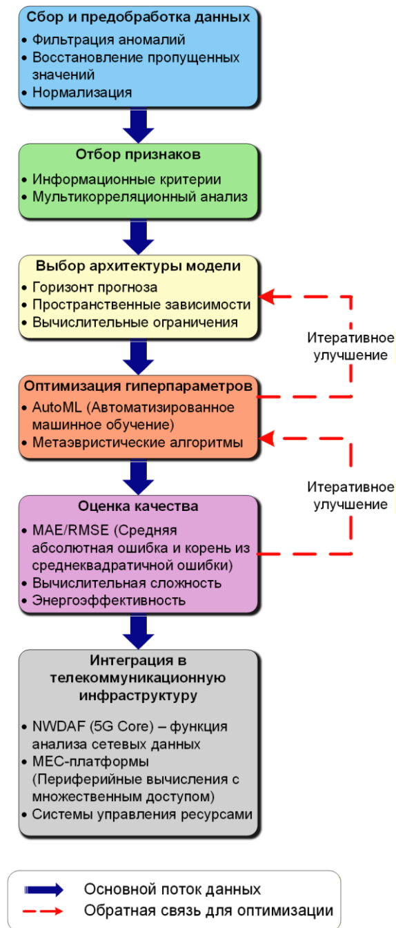
Рис. 2. Системная архитектура методики прогнозирования трафика
