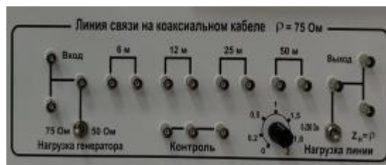
Рис. 2. Область для исследования коаксиальных кабелей на стенде ТЛС-02
