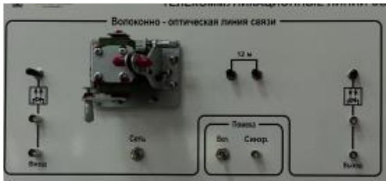
Рис. 4. Область для исследования оптоволоконных кабелей на стенде ТЛС-02
