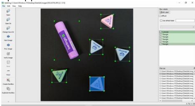
Рис. 2. Пример разметки изображений в программе LabelImg
