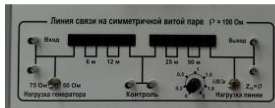
Рис. 3. Область для исследования симметричных кабелей на стенде ТЛС-02
