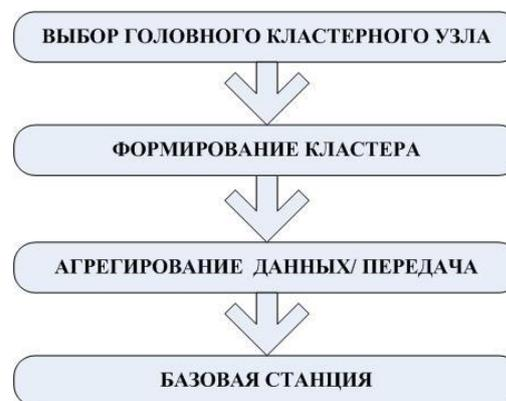
Рис. 1. Архитектура алгоритма LEACH
