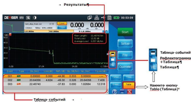
Рис. 4. Внешний вид окна рефлектометра серии AE3100
