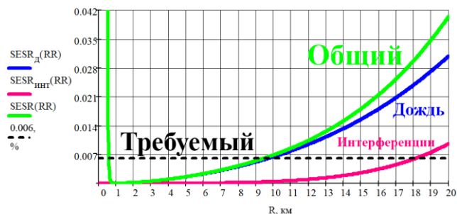
Рис. 5. Рассчитанные зависимости параметров SESR с пересечением на уровне его допустимого значения
